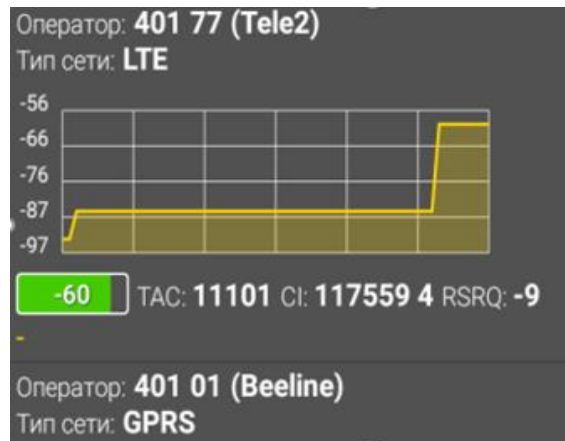
Рисунок 5- График уровня сигнала для технологии LTE с помощью программы Netmonitor (sector A)
