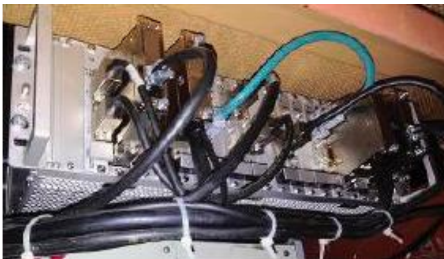
Рисунок 5 – Бортовой модуль STM для приема кодов АЛСН
