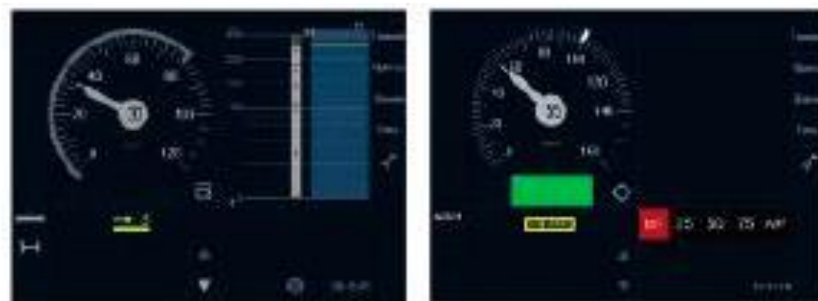
Рисунок 4 – Дисплей БСБ в режиме СИРДП-Е (слева) и АЛСН (справа)
