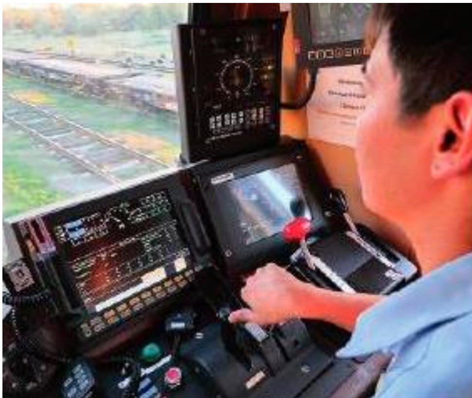
Рисунок 3 – Дисплей БСБ в кабине машиниста (сверху над пультом размещен дисплей системы КЛУБ, который позднее была демонтирована)
