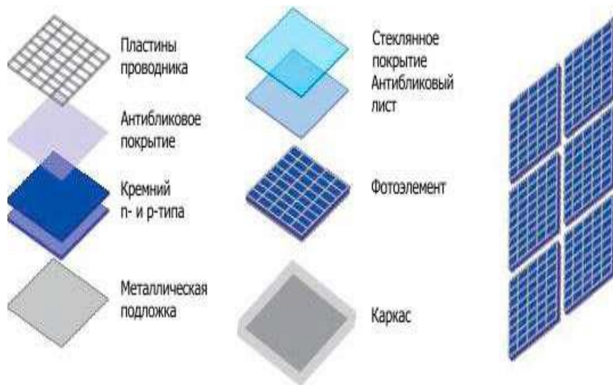
Рисунок 1.1 – Послойное строение солнечной панели
