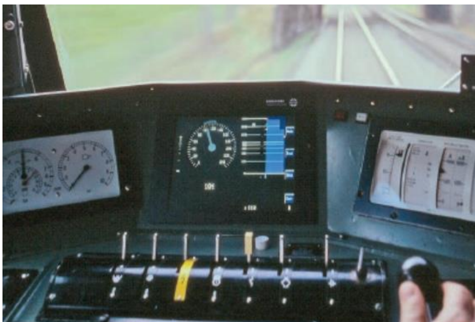
Рисунок 4 – Дисплей системы СИРДП-Е на пульте машиниста
