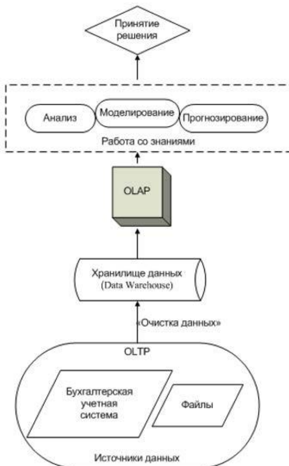
Рисунок 2 – Процесс работы с данными в информационных системах
