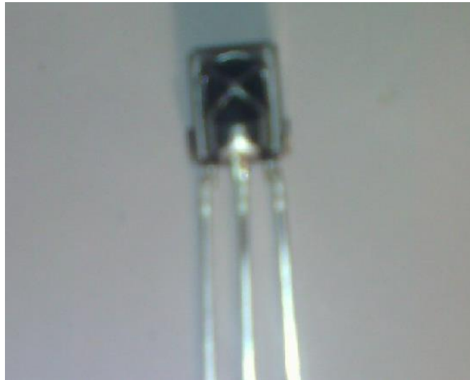
Рисунок 1 – Внешний вид приемника VS1838B
