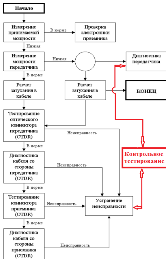
Рисунок 1 – Алгоритм поиска неисправностей на ВОСП
