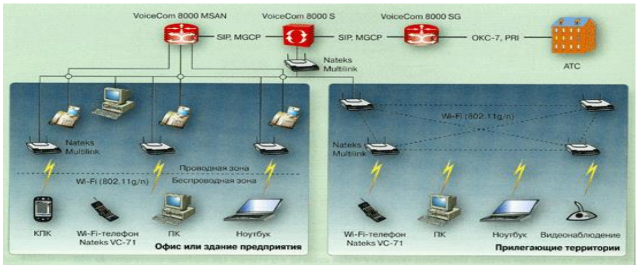
Рисунок 3 - Возможный способ организации связи на предприятии с использованием как проводного, так и беспроводного доступа
